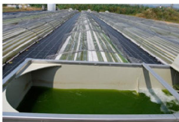
Figura 2. Imagen de los tres fotobiorreactores instalados en Agròpolis-UPC y detalle de la parte izquierda del tanque abierto de uno de los fotobiorreactores.
